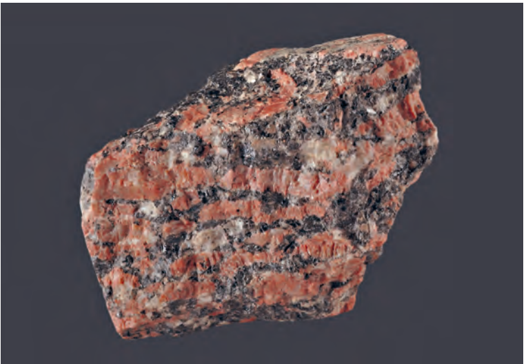
Foto 38: Geregeltes Gefüge („Fließgefüge“) in einem Granit. Kalkfeldspat rot, Plagioklas weißlich, Quarz grau und Biotit schwarz. Breite 10 cm.
